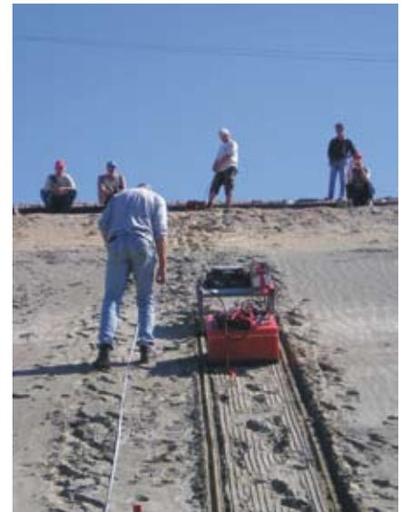
→ ABB. 30 Bodenradar-Untersuchungen auf einem Sanddamm
