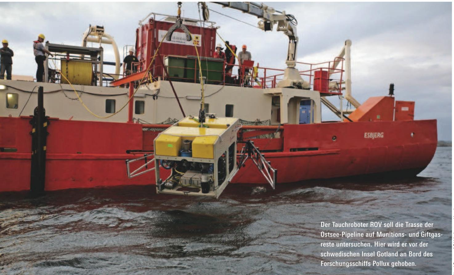
Der Tauchroboter ROV soll die Trasse der Ostsee-Pipeline auf Munitions- und Giftgasreste untersuchen. Hier wird er vor der schwedischen Insel Gotland an Bord des Forschungsschiffs Pollux gehoben.
